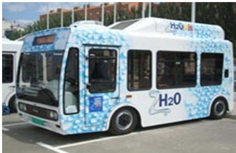
Figura 11. MiniBus de pila de combustible de hidrógeno.
