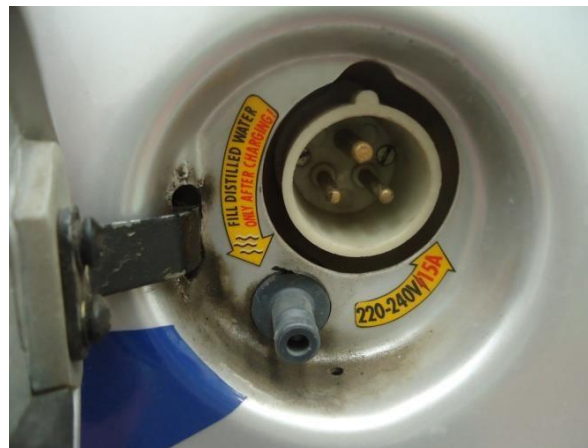
Figura 10. Punto de carga del vehículo.
