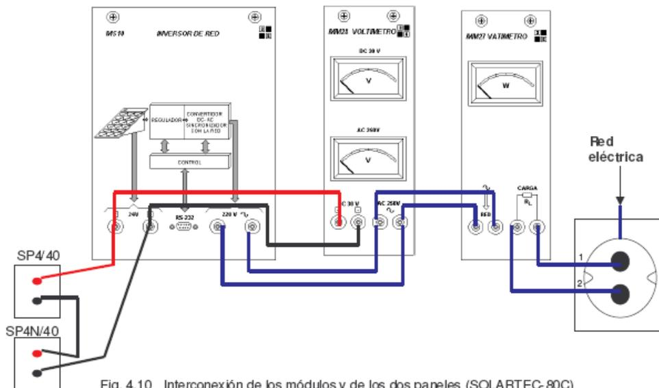
Fig. 4.10 Interconexión de los módulos y de los dos paneles (SOLARTEC-80C) para la conexión a red y medida de sus parámetros.
