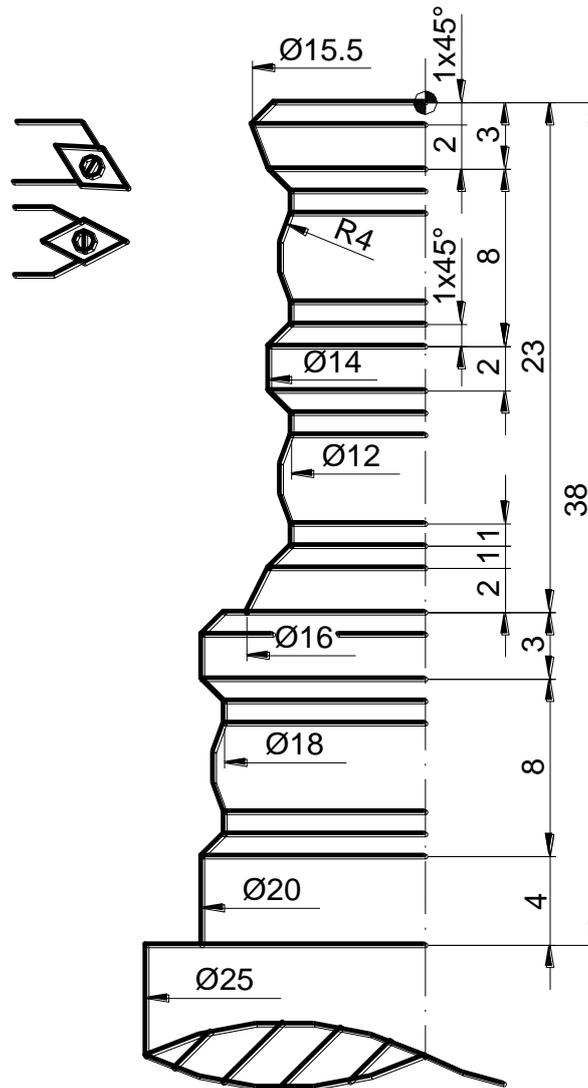
Plano de la pieza a mecanizar
