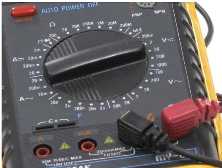
Si observamos el selector en la zona de resistencia eléctrica vemos que existen varias escalas que van desde  $200\ \Omega$  hasta  $200\text{M}\Omega$ . Esta numeración indica el valor máximo que es capaz de medir esa escala. Veamos un ejemplo.
