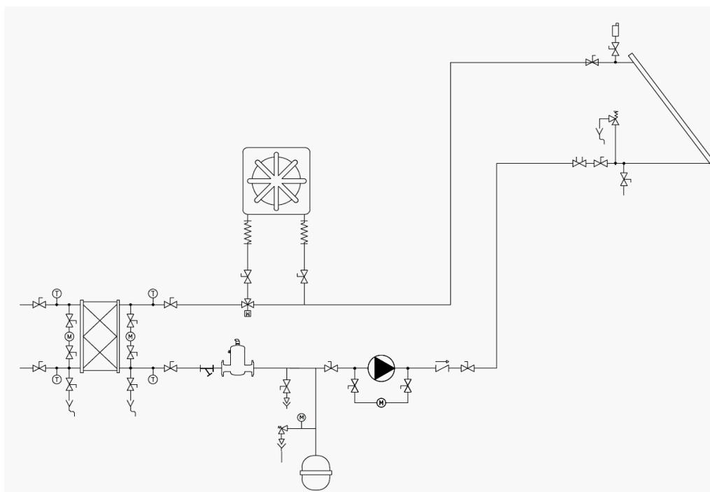
Fig. 14: Esquema con intercambiador externo.
