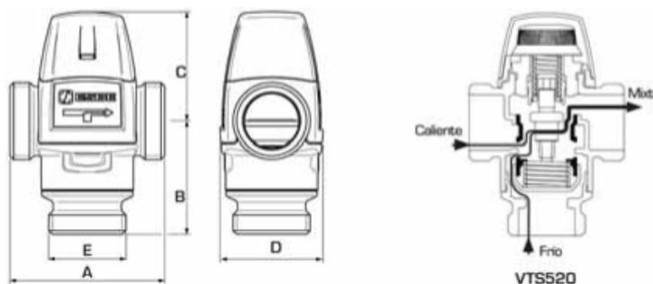
Fig. 20: Válvula mezcladora termostática (Salvador Escoda). Ejemplo.
