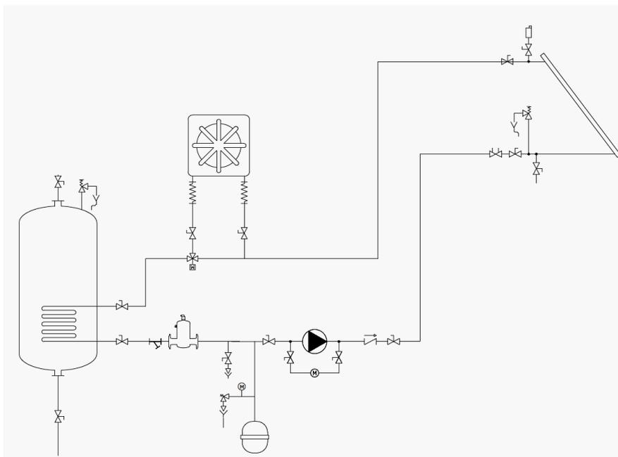
Fig. 9: Esquema con intercambiador interno.
