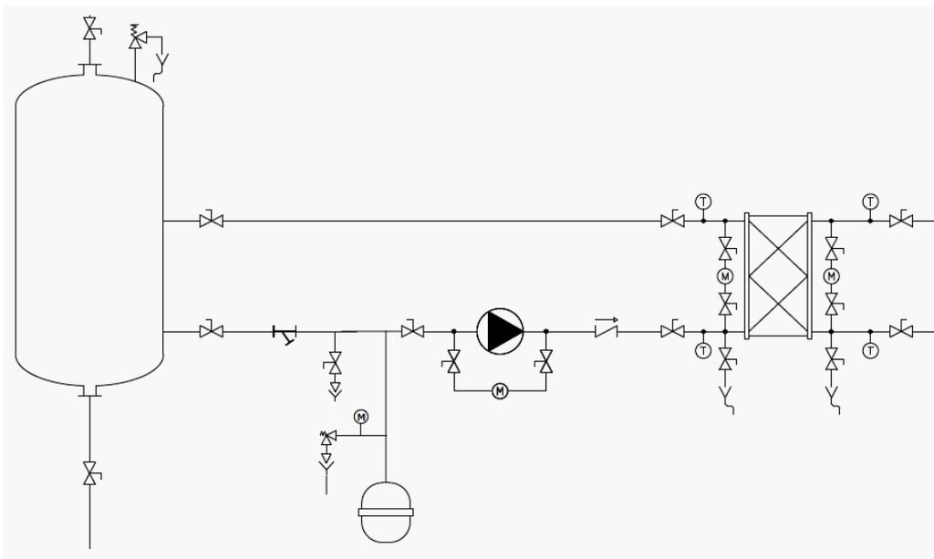
Fig. 25: Circuito secundario en un esquema de principio.
