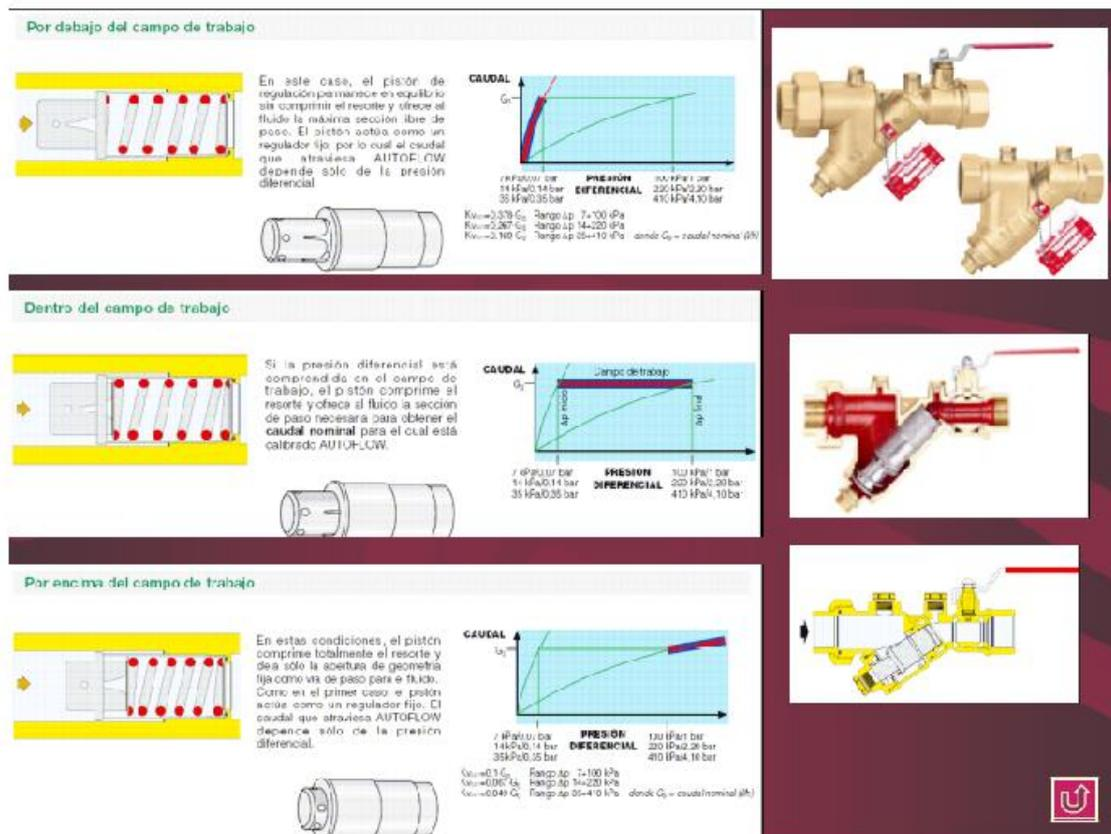
Fig. 19: Válvula reguladora de caudal autoflow (Caleffi). Ejemplo.
