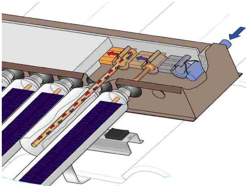
Fig. 35: Detalle del captador solar de tubos de vacío a montar durante la práctica. (Lumelco).
