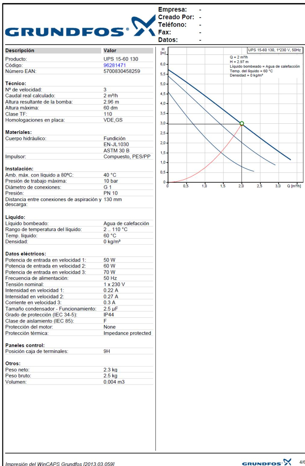
Fig. 16: Electrocirculador (Grundfos). Ejemplo.
