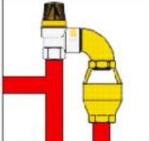
Fig. 7: Válvula de seguridad (Caleffi). Ejemplo.
