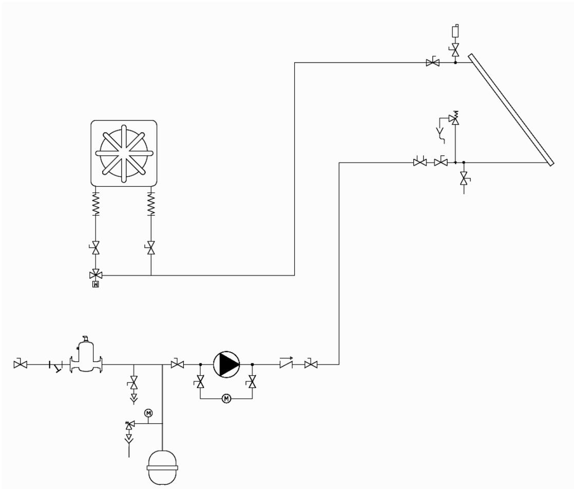
**Fig. 23: Aerotermo disipador en el esquema de principio.**
