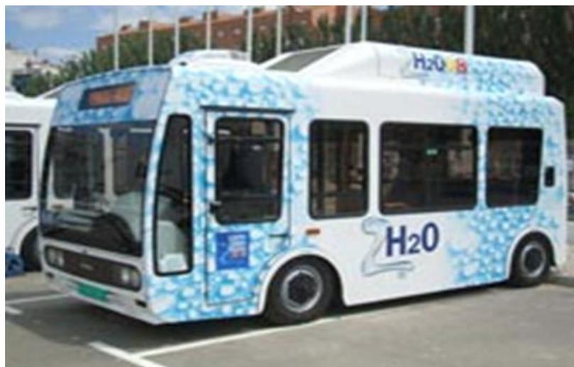
Figura 11. MiniBus de pila de combustible de hidrógeno.
