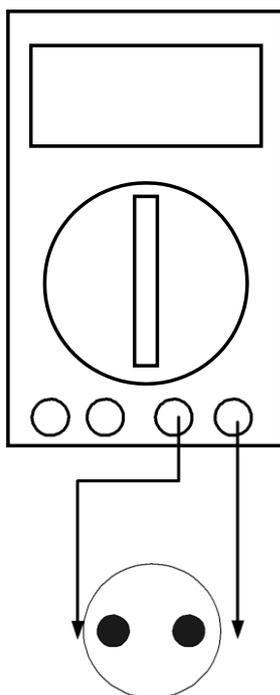
**Amperímetro.** Esta función nos mide la cantidad de electricidad que recorre un conductor, por ejemplo la intensidad que consume un tubo fluorescente o la intensidad que recorre la fase de un motor.
