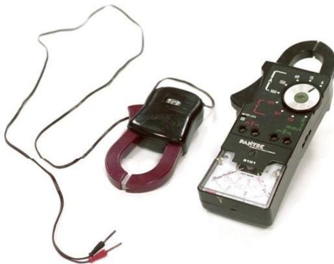
Para medir la intensidad de un circuito con una pinza amperimétrica, debemos abrazar uno solo de los cables del circuito para obtener un resultado válido. Si por ejemplo en un circuito de corriente alterna con conductores activos fase y neutro abrazáramos los dos, el resultado que obtendríamos del aparato de medida sería 0 ya que la suma vectorial de la intensidad en cada uno de los conductores es igual a 0. Por otro lado en un circuito trifásico sucede lo mismo, si abrazamos los tres
