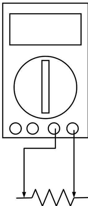
**Voltímetro.** Esta función del polímetro nos mide la diferencia de potencial entre dos puntos. Es quizá la medición más utilizada con este dispositivo y la que nos va a resolver la mayoría de dudas en las averías más frecuentes. Para medir el voltaje en una instalación es obvio que debemos hacerlo con el circuito activo, es decir, bajo tensión.
