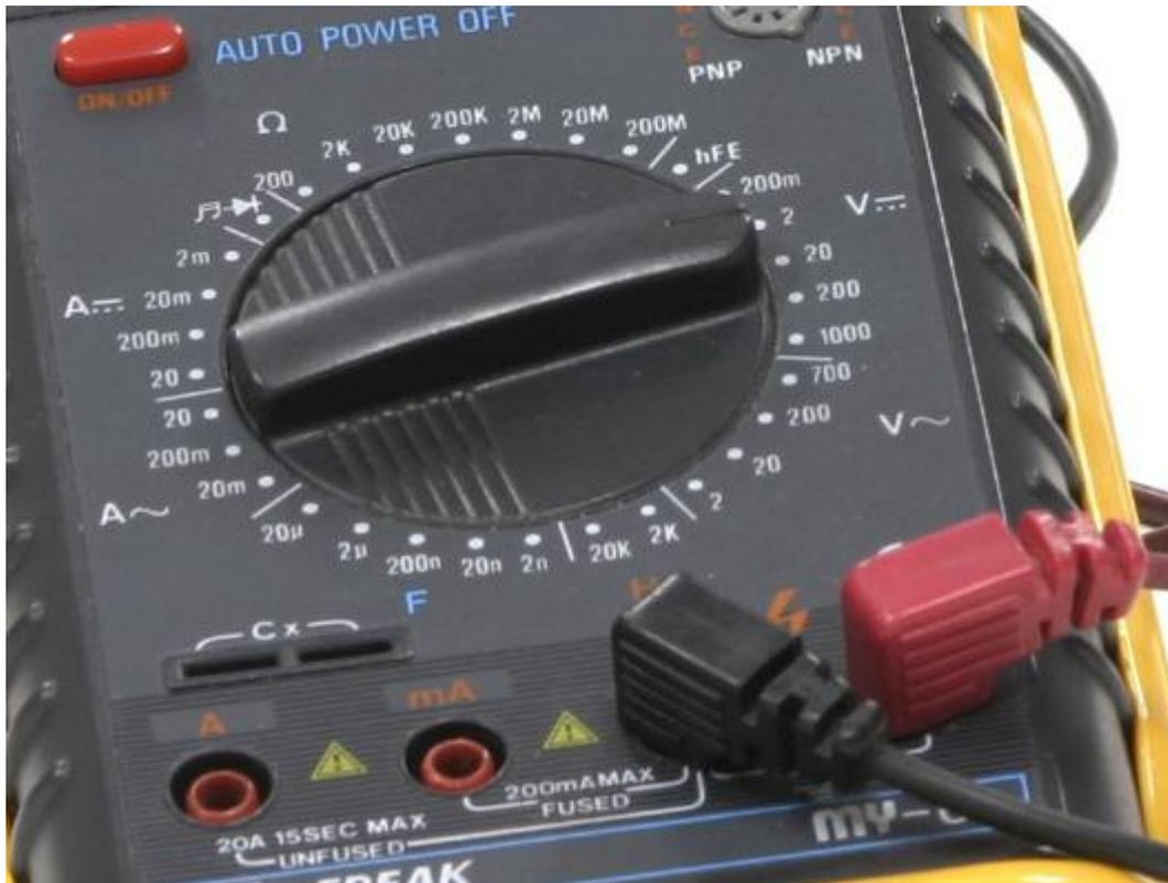
Si observamos el selector en la zona de resistencia eléctrica vemos que existen varias escalas que van desde 200  $\Omega$  hasta 200M $\Omega$ . Esta numeración indica el valor máximo que es capaz de medir esa escala. Veamos un ejemplo.
