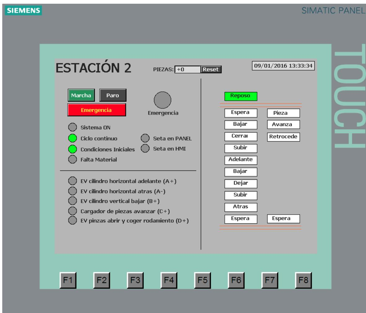
Figura 2.- Panel táctil de estación 2.
