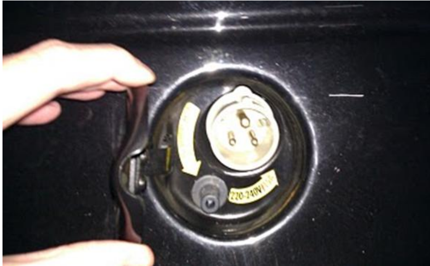
Ilustración 4. Punto de carga del vehículo
